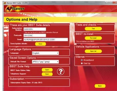
4. Le bouton **'Tests and checks'** permet d'effectuer les tests de fonctionnement du BBST et de capacité de connexion au site Internet et de téléchargement de la dernière version du logiciel.
