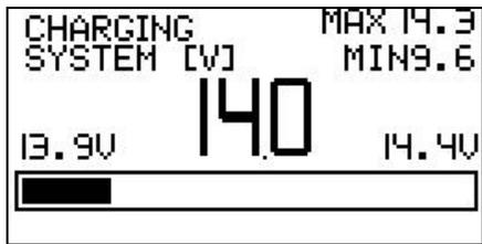
L'état de la batterie lors de la charge s'affichera une fois l'alternateur stabilisé.
